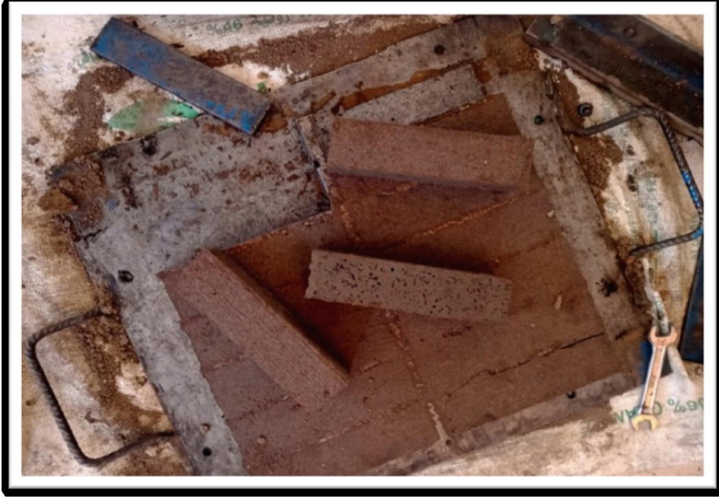
صورة رقم (14.II): توضح لحظة نزع أحد العينات من القالب
