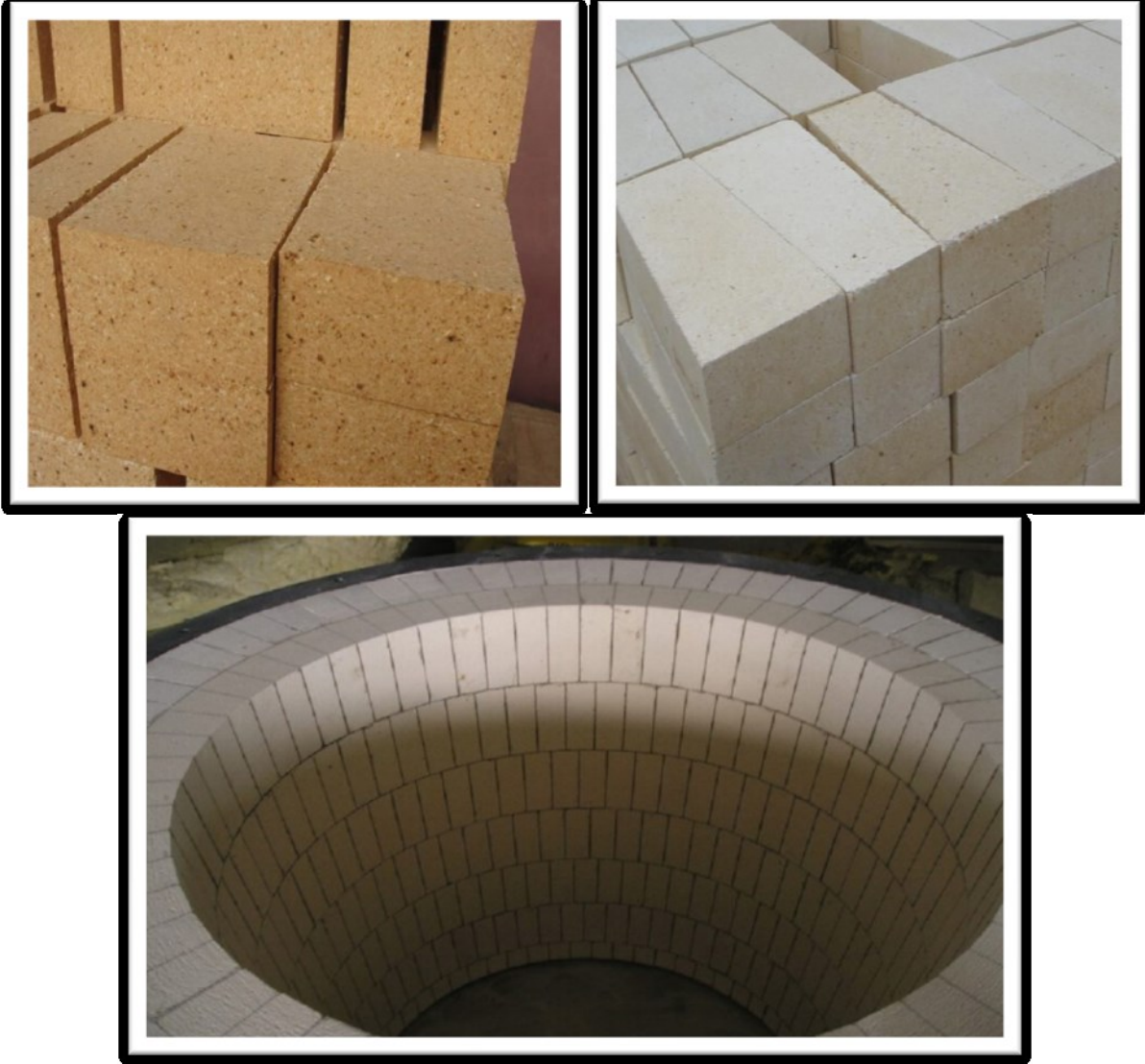
صورة رقم (6.I): توضح الشكل الصناعي لطوب الحراري المينوسيليكا
