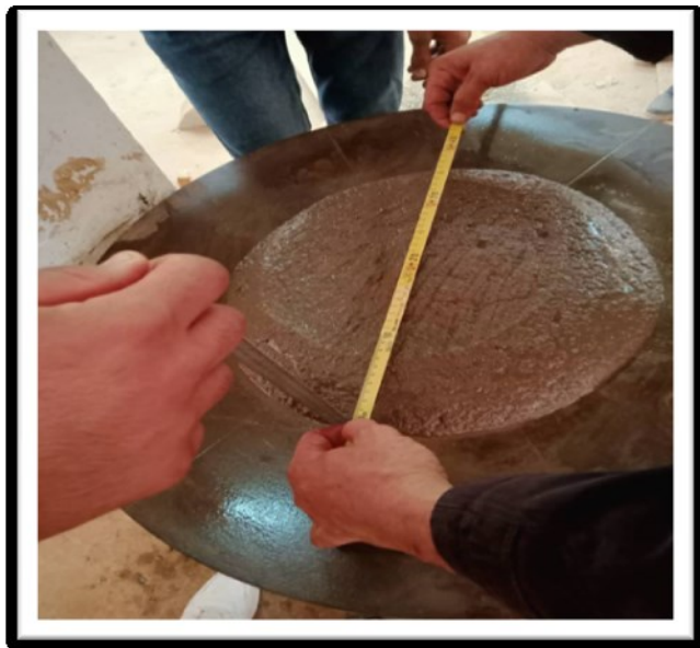
صورة رقم (13.II): توضح شكل الخلطة فوق طاولة الهز
