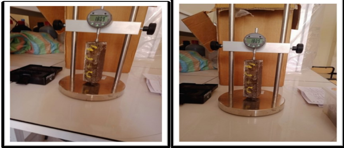
صورة رقم (7.III): نتائج تجربة الانكماش
