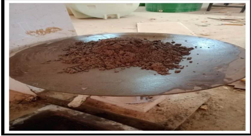
صورة رقم (9.II): توضح شكل الخلطة فوق طاولة الهز
