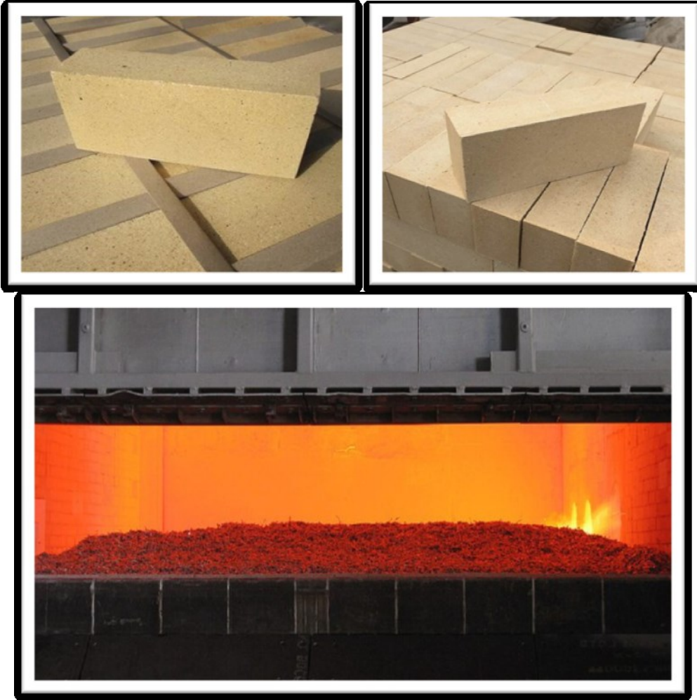
صورة رقم (7.1): توضح الشكل الصناعي لطوب الحراري المينوسيليكات
