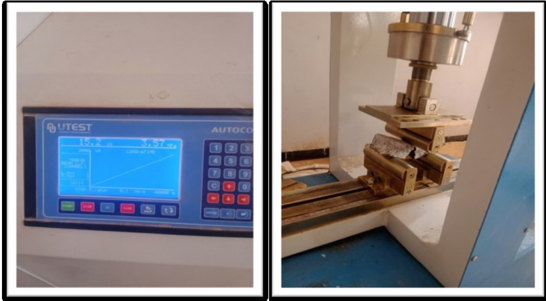
صورة رقم (3.III): توضح تجربة الانحناء
