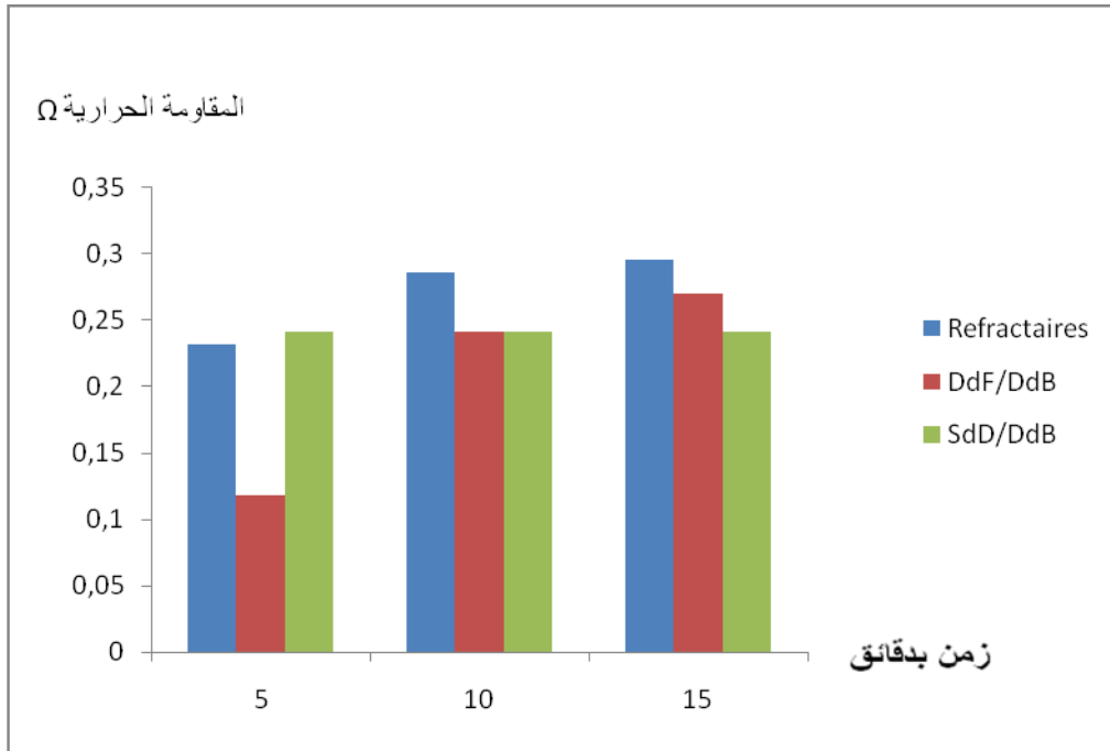
منحنى رقم (10.III): يوضح المقاومة الحرارية بدلالة الزمن
