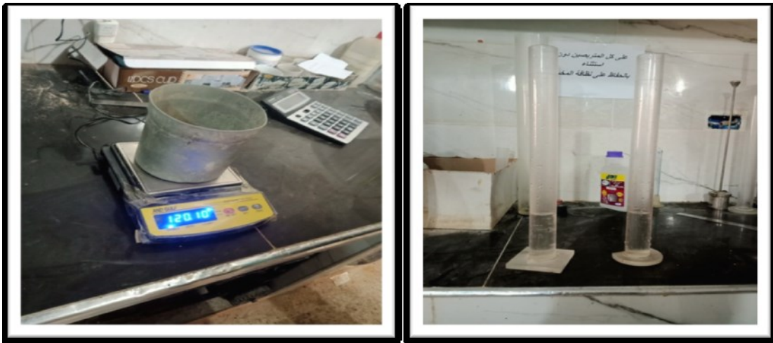
صورة رقم (4.II): توضح المكافئ الرملي لرمال الكثبان
