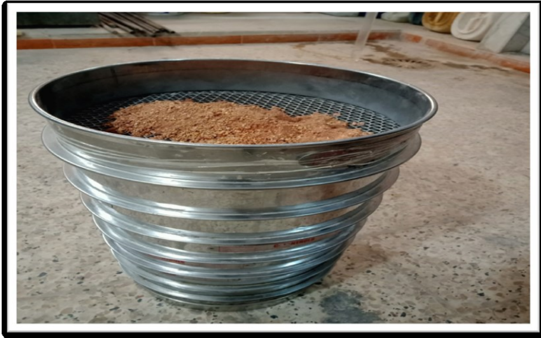
صورة رقم (3.II): توضيح الغراييل المستعملة
