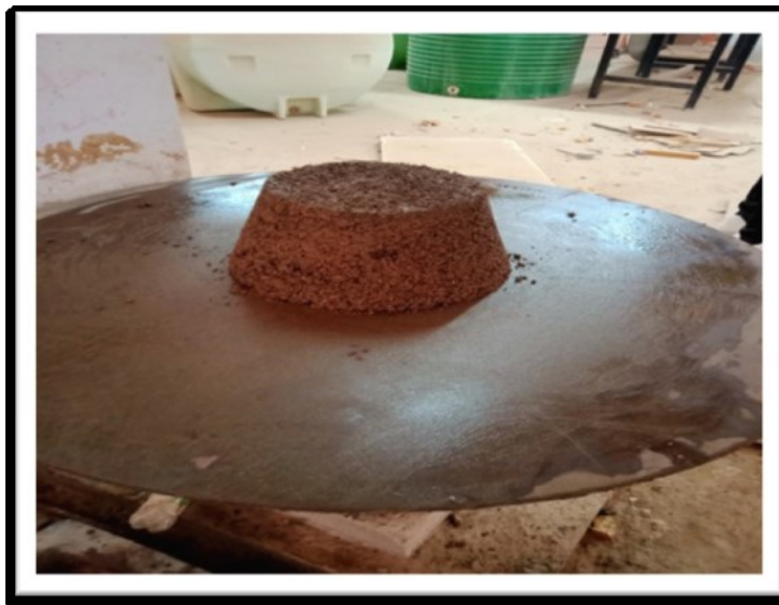
صورة رقم (8.II): توضح شكل الخلطة فوق طاولة الهز
