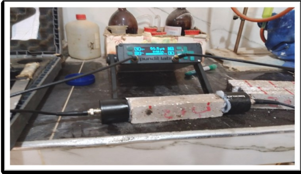
الصورة رقم (1.III): توضح جهاز قياس الأمواج الصوتية
