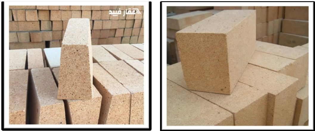
صورة رقم (9.I): توضح الشكل الصناعي للطوب القلوي المقاوم للحرارة (طوب المغنيزيا)
