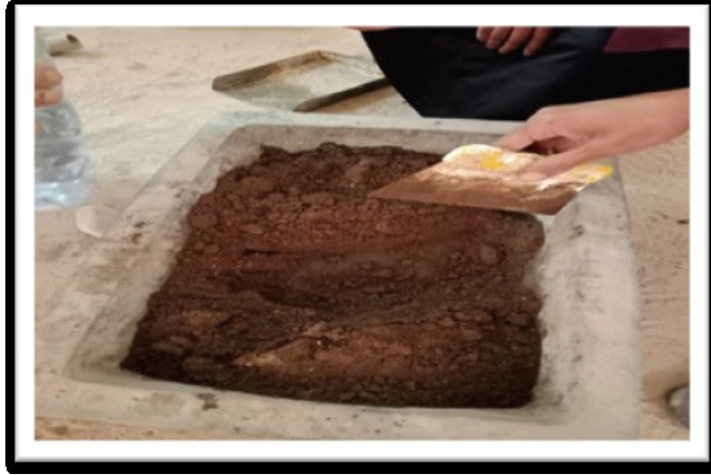
صورة رقم (11.II): توضح شكل الخلطة فوق طاولة الهز
