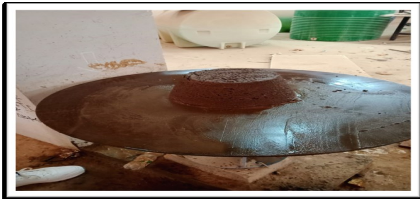
صورة رقم (10.II): توضح شكل الخلطة فوق طاولة الهز
