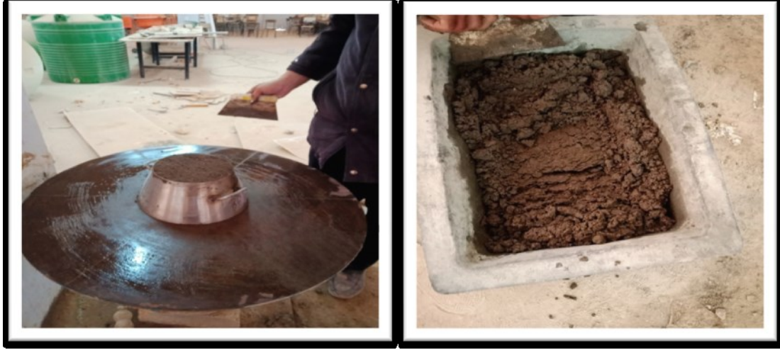
صورة رقم (12.II): توضح شكل الخلطة فوق طاولة الهز
