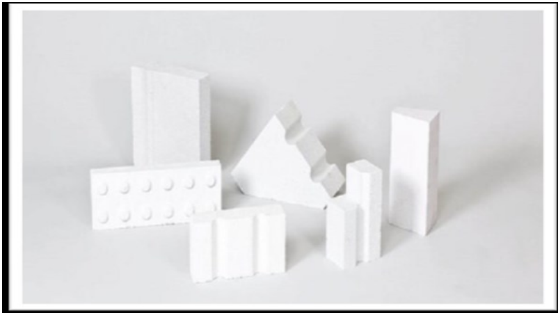
صورة رقم (8.I): توضح الشكل الصناعي للطوب السيليسي المقاوم للحرارة
