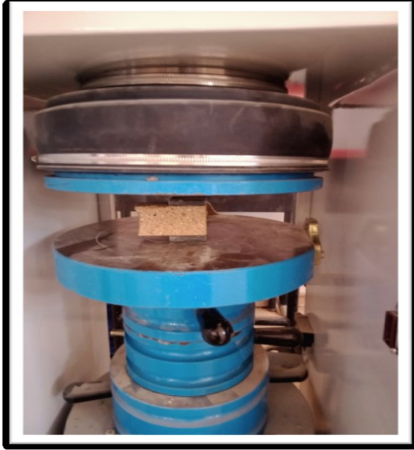
صورة رقم (4.III): توضح تجربة الضغط للعينة الشاهد
