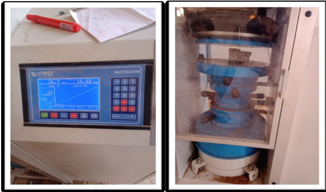
صورة رقم (6.III): توضح تجربة الضغط للعينات ( SdD/DdB )
