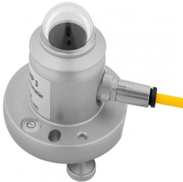
Figure III.13 – le pyranomètre CMP3.
