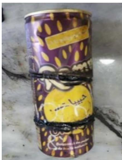
Figure 4.08: Prélèvement d'éprouvettes pour l'essai de stabilité au stockage.
