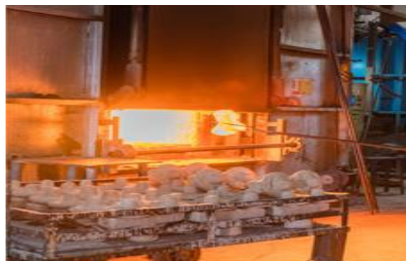
Figure I.29 : Moulage à la cire perdue des superalliages[5].
