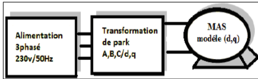
Figure I.5 Schéma bloc de démarrage sans onduleur
