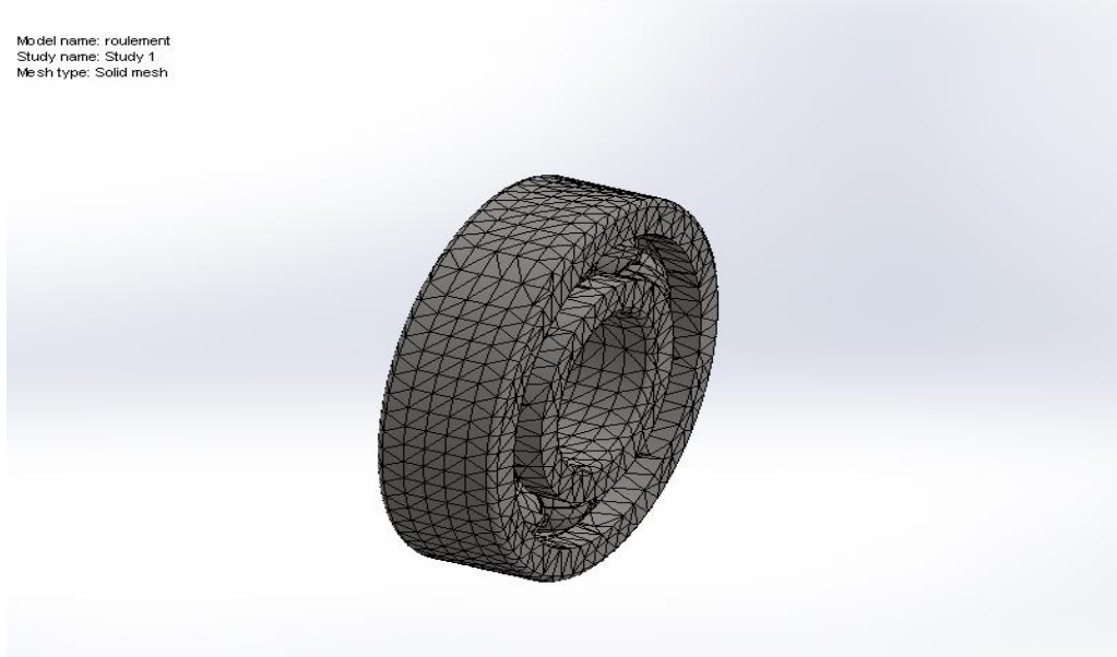
Figure IV.15: Maillage de roulement d'étude
