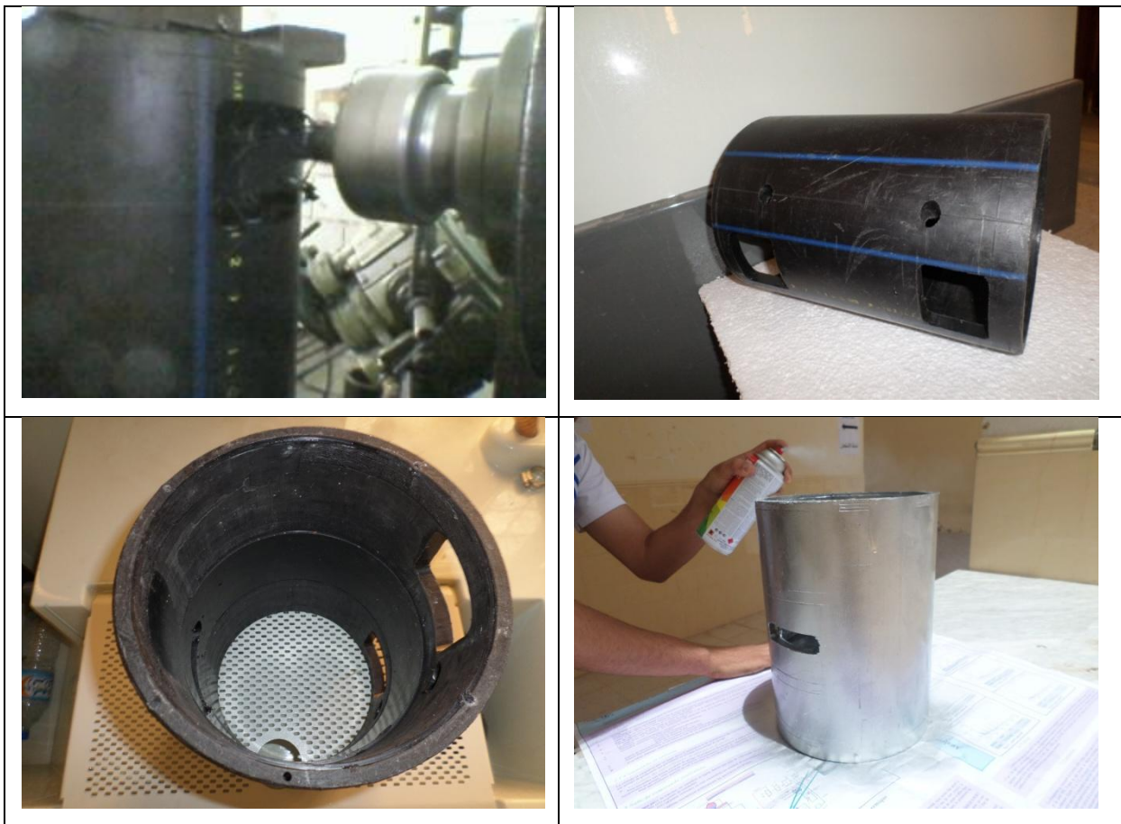
Figure II.1 usinage et finition du carcasse de la turbine
