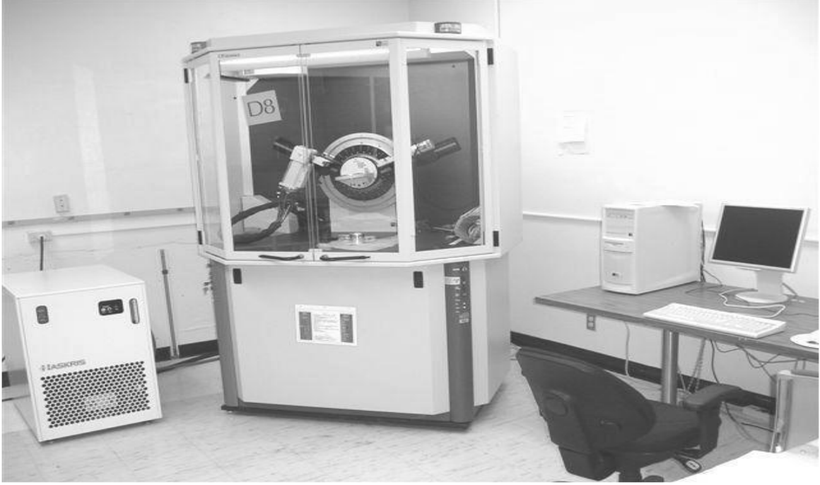
الصورة (09): صورة لجهاز انعراج الاشعة السينية
