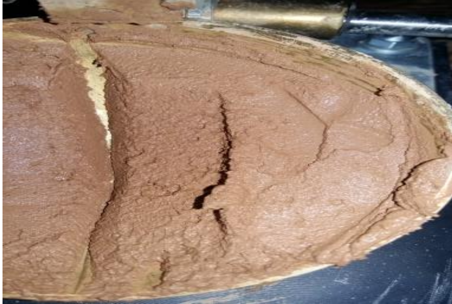
الصورة (04): العينة بجهاز كازكراند لتجربة حدود اترياك حد السيولة
