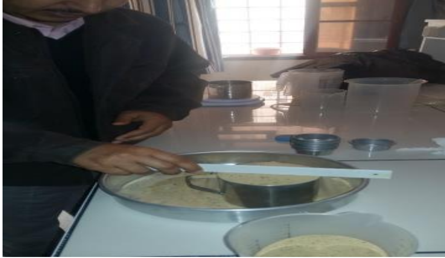
الصورة (07): توضيح تجربة الكتلة الحجمية
