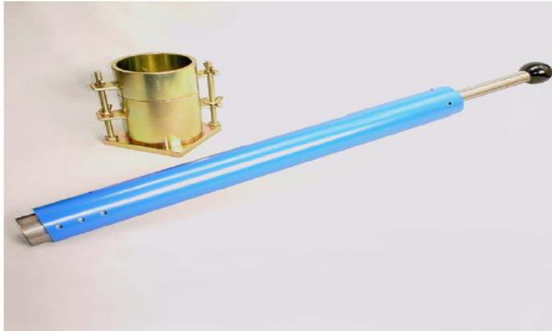
الصورة 06 القالب القياسي لدمك التربة.
