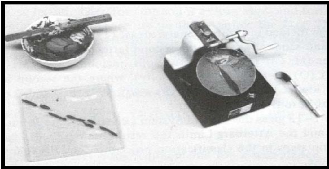
الصورة 07 أجهزة تحديد حدي السيولة واللدونة.
