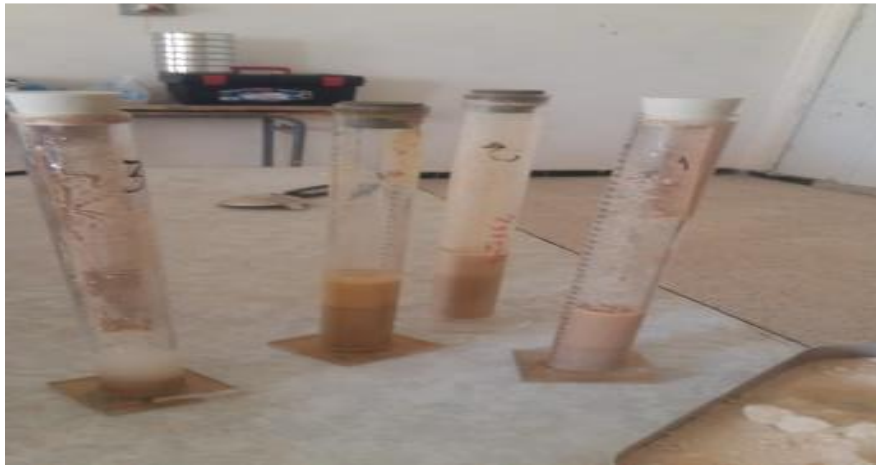
الصورة (09): توضيح العينة بعد الرج تجربة المكافئ الرملي
