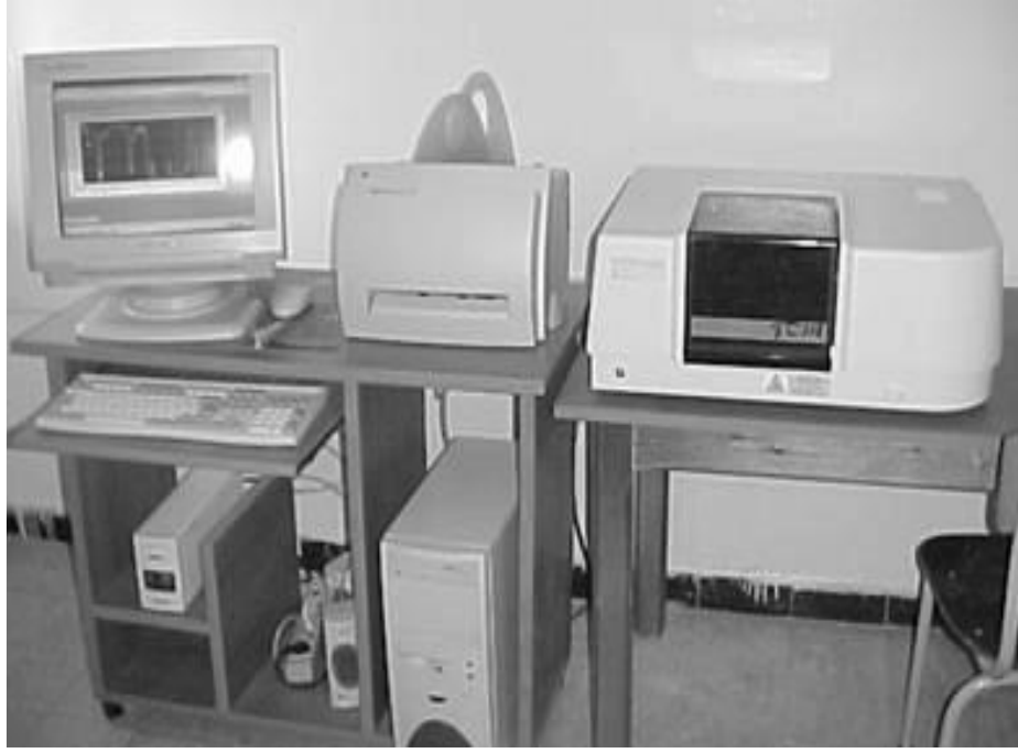
الصورة (08): مطياف الامتصاص ما تحت الأحمر ولواحقه
