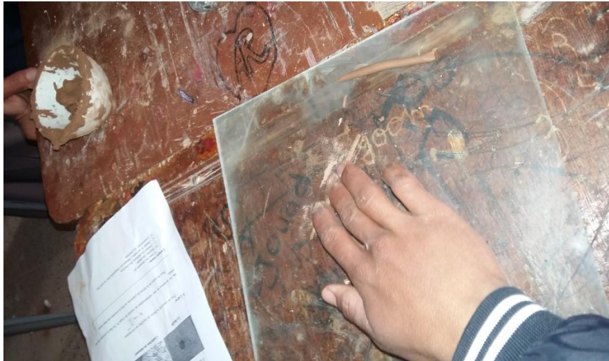
الصورة (06): توضيح عملية دحرجة العينة لتجربة حدود اترباك حد اللدونة
