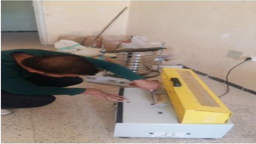
الصورة (08): توضيح جهاز الرج تجربة المكافئ الرملي
