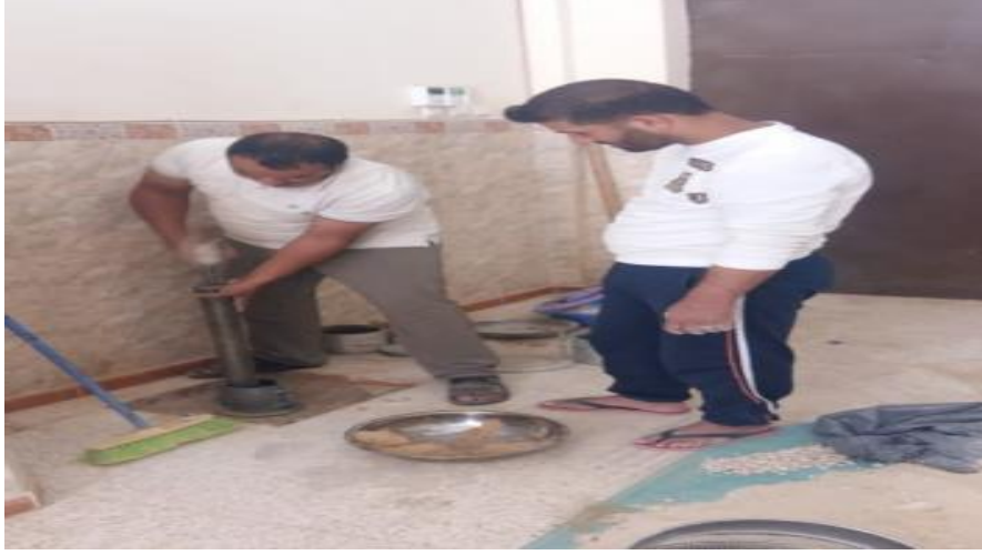
الصورة (10): توضيح عملية دمك العينة لتجربة برक्टर
