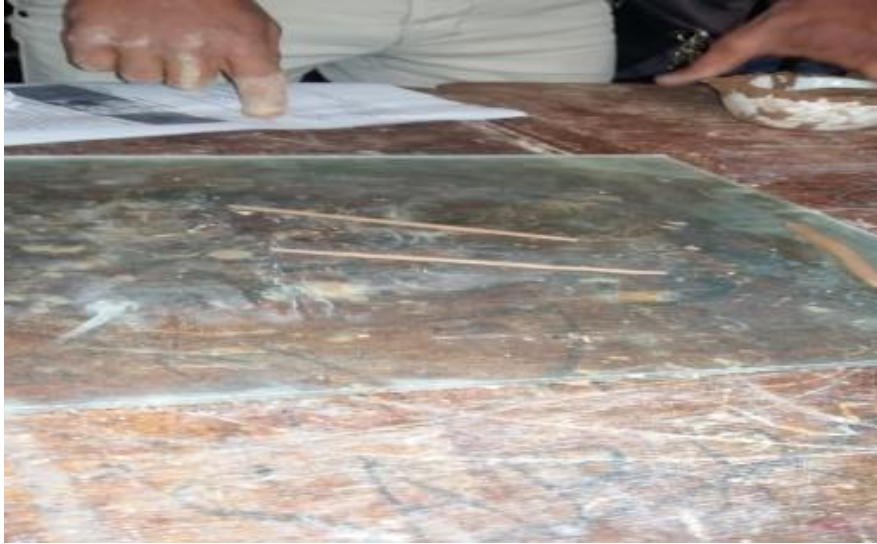
الصورة (05): توضيح العينة لتجربة حدود اترباك حد اللدونة
