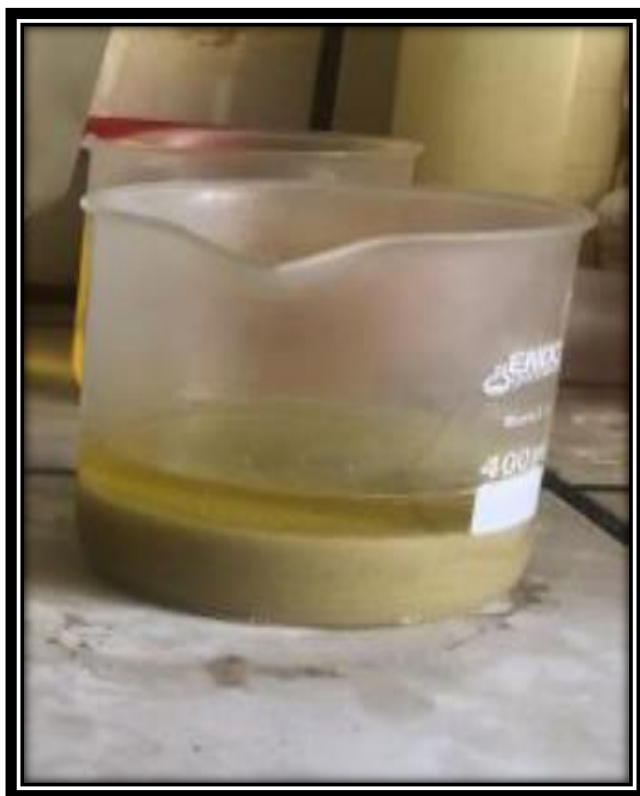
شكل (II-4): غمر العينة بالحمض
