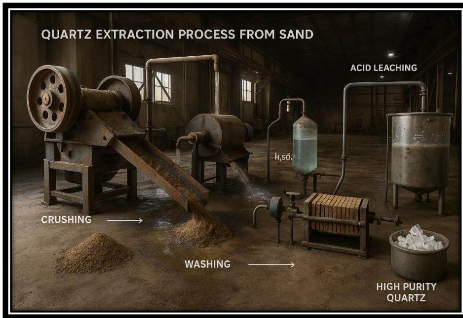
شكل (I-4): مراحل استخلاص الكوارتز [12].
