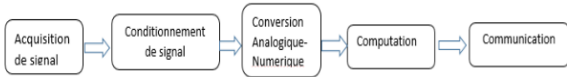
Figure I-11: Les blocs fonctionnels du compteur intelligent.
