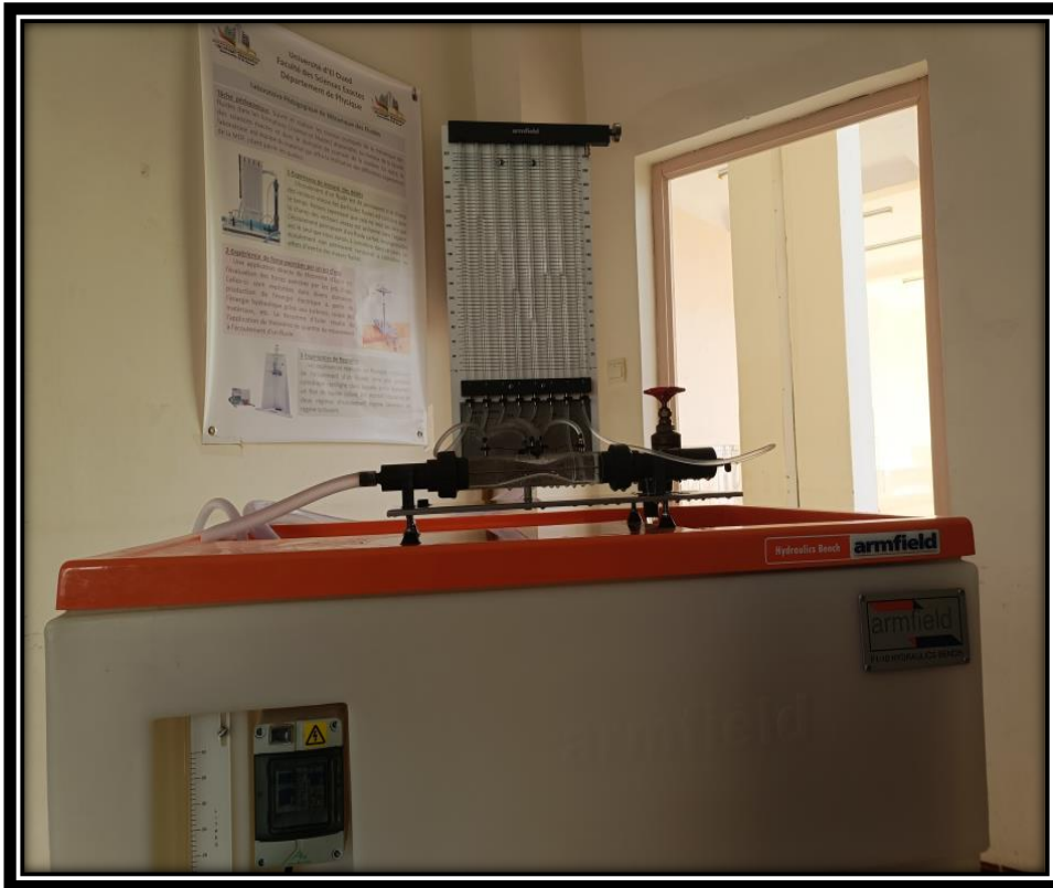
الشكل (1-IV): صورة توضح مقياس فنتوري المستخدم موضوع فوق المقعد الهيدروليكي
