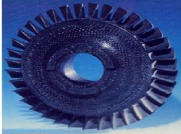
Fig.I.17: Disque de turbine et aubes HP [6].
