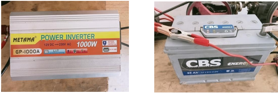
Figure (III.19) : Images représente l'Onduleur monophasé et la Batterie de stockage.
