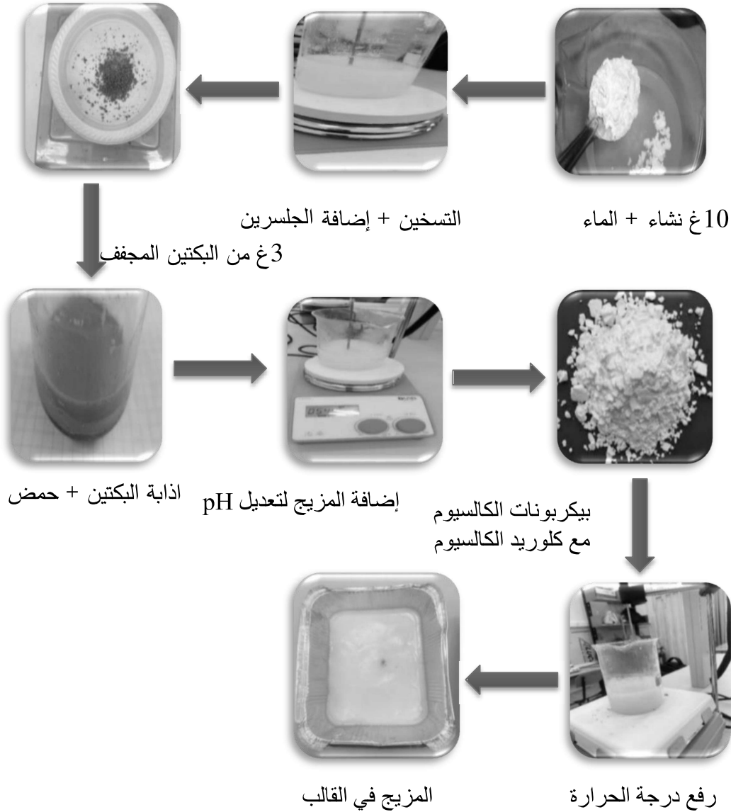
الشكل (III-9): مراحل إنتاج البلاستيك الحيوي المدعم بالراتينج.
