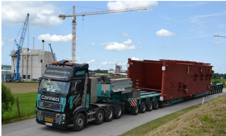
Figure 4.3 : Transport d'une chaudière de centrale à bois capable de soutenir une pression de 100 bars
