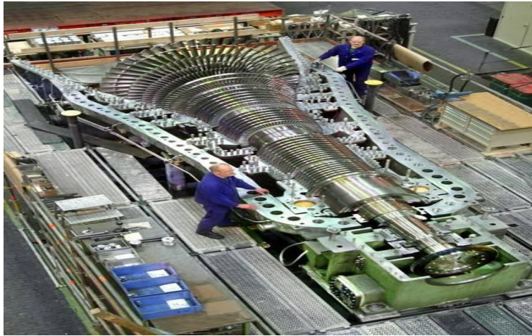
Figure 4.5 : Turbine d'une centrale à vapeur de taille moyenne.
