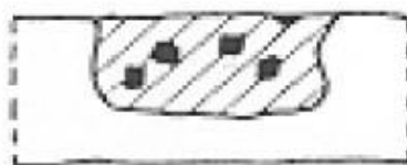
Figure I-5: Corrosion et dissolution sélective.
