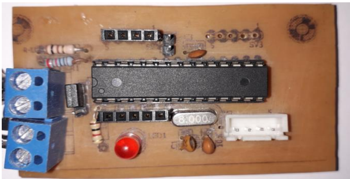
Figure(V-14) : Circuit imprimé du circuit de commande.
