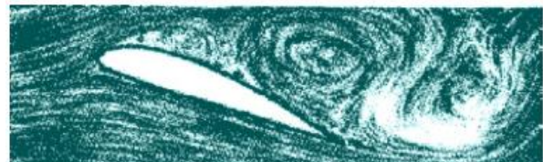
Écoulement autour d'une pale en décrochage aérodynamique ( 0 < \beta < 90^\circ )
