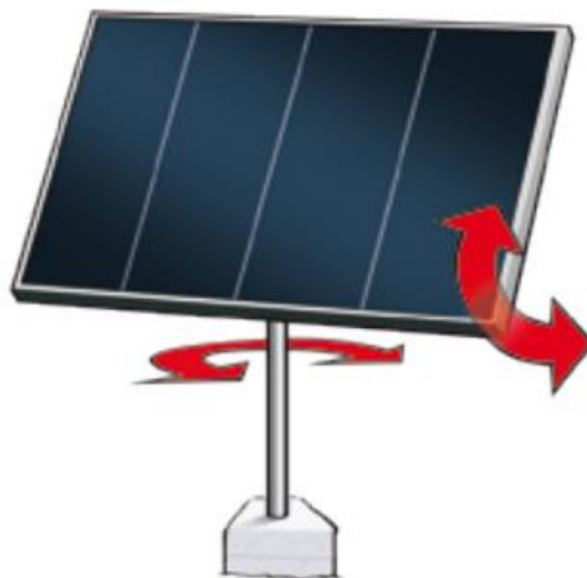
Figure (II.4) : Panneau solaire avec système de poursuite bi-axiale [29].
