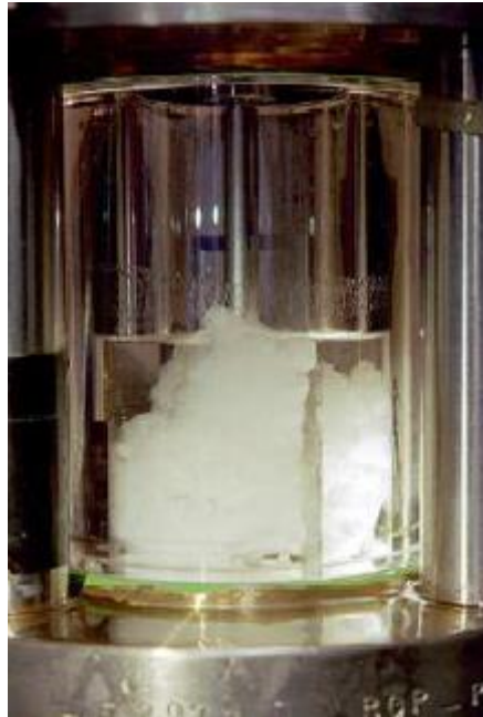
Figure 3: Formation d'hydrates de gaz dans un réacteur agité transparent [3].
