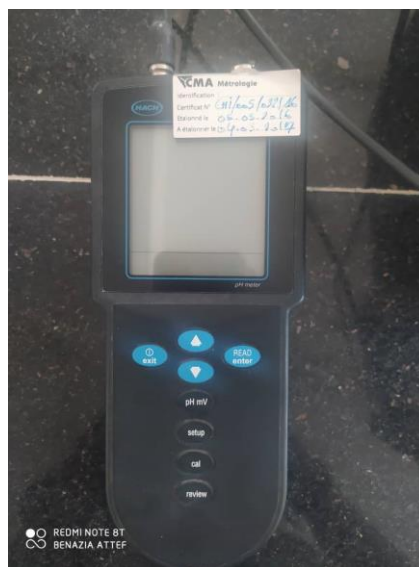
Figure 08: pH Mètre (pH 510) de marque « hach »
