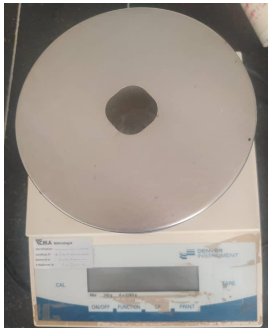
Figure13 : Balance (0.001 g de précision) de marque « Denver »
