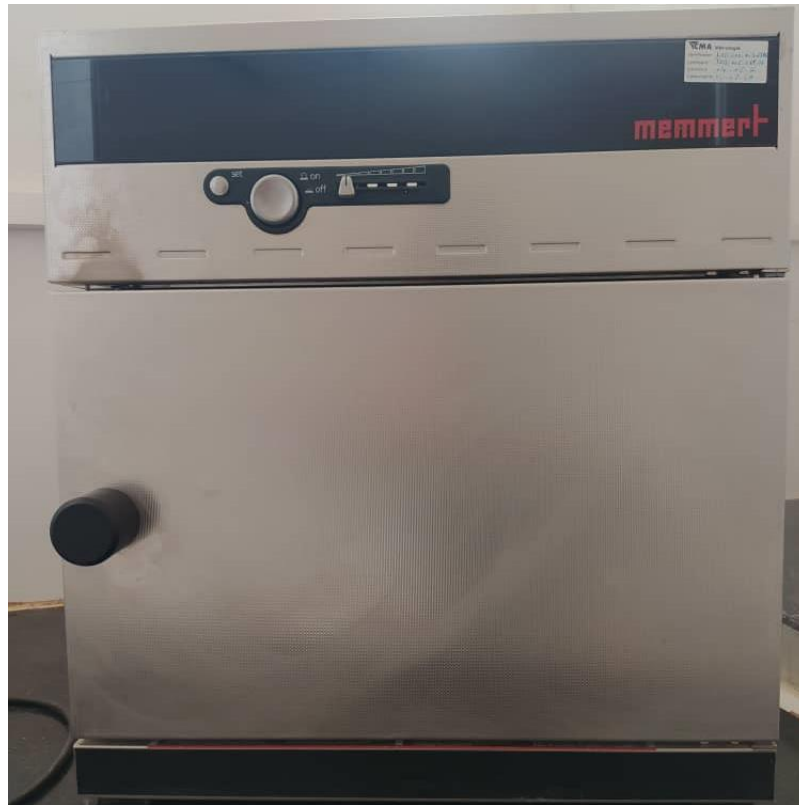
Figure 12 : Etuve chauffé (105°C) de marque « memmert »
