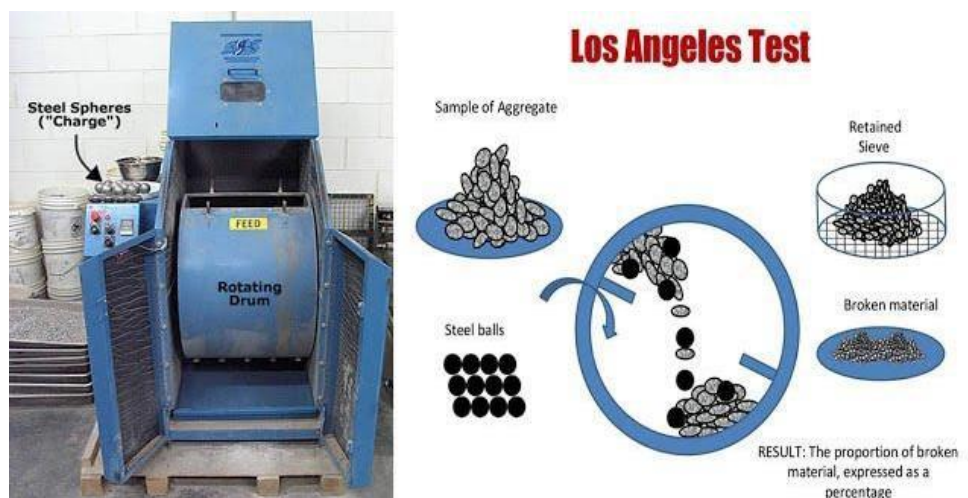
Figure 2.4 – Machine normalisée de l'essai Los Angeles pour la mesure de la résistance aux chocs et à la fragmentation des granulats routiers (NF EN 1097-2).
