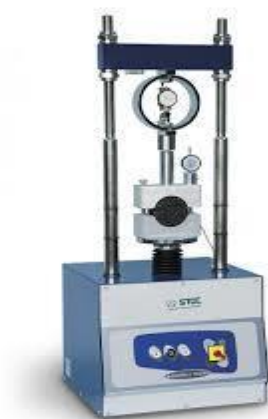
Figure 4.7 : Essai Marshall pour les enrobés.
