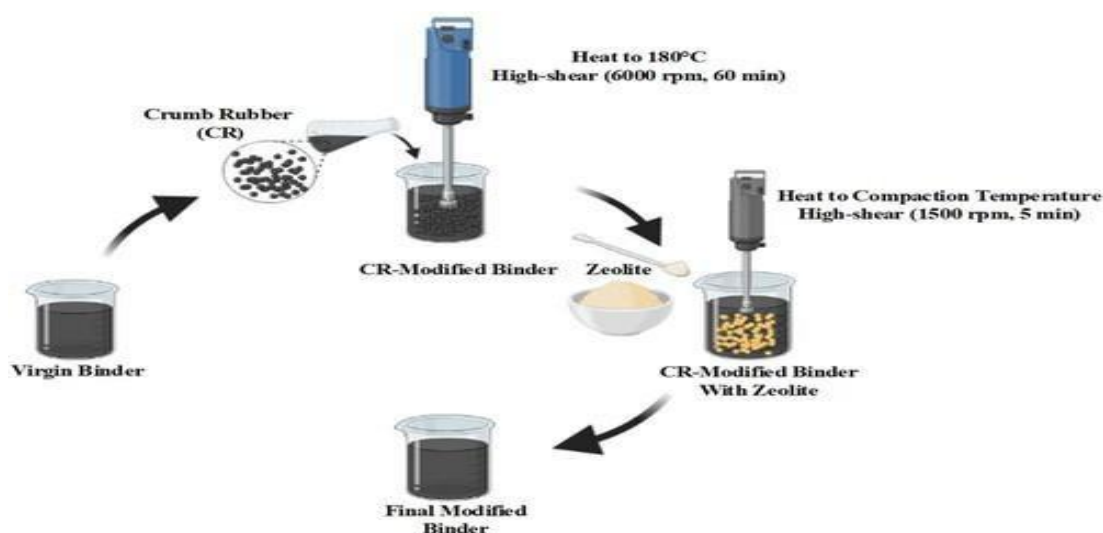
Figure 3.2 – Schéma industriel du procédé de modification par voie humide ( wet process ) illustrant l'intégration de la poudrette d'élastomère et l'homogénéisation sous cisaillement intense [14].
