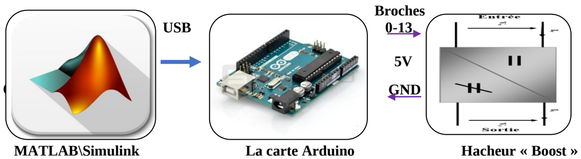
Fig. (III-25). Schéma de liaison l'Arduino avec logiciel MATLAB\Simulink et hacheur « Boost ».
