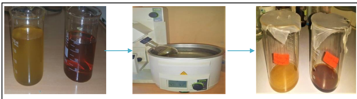
الشكل 3.IV: تبخير المذيبات بواسطة المبخر الدوراني.
