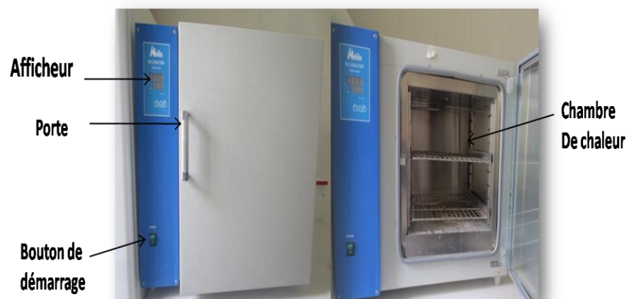
Figure 28 : Étuve de marque Nahita (photo original )
