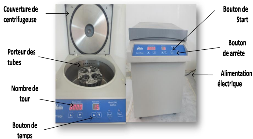
Figure 26 : Centrifugeuse horizontale de marque Nahita (photo original ).
