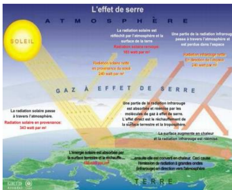
Figure I.1 Schéma explicatif de l'effet de serre.
