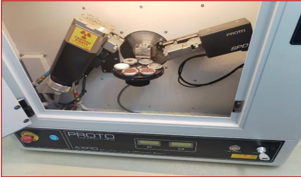
الشكل (III-5): جهاز الانعراج الآلي من النوع PROTO AXRD Benchtop
