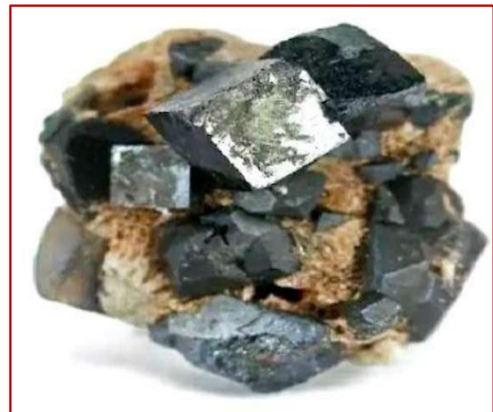
الشكل (I-1): بيروفسكايت تيتانات الكالسيوم (\text{CaTiO}_3) [2].
