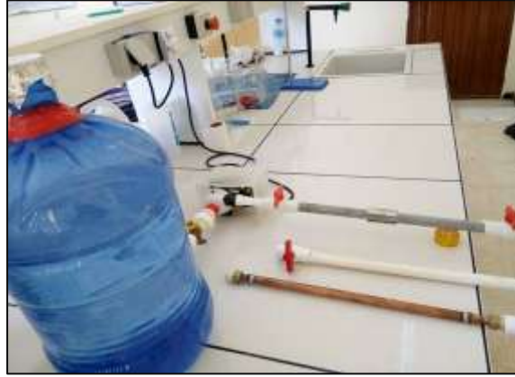
شكل رقم 5: التركيب التجريبي للحصول على عينات مياه معالجة مغناطيسية
