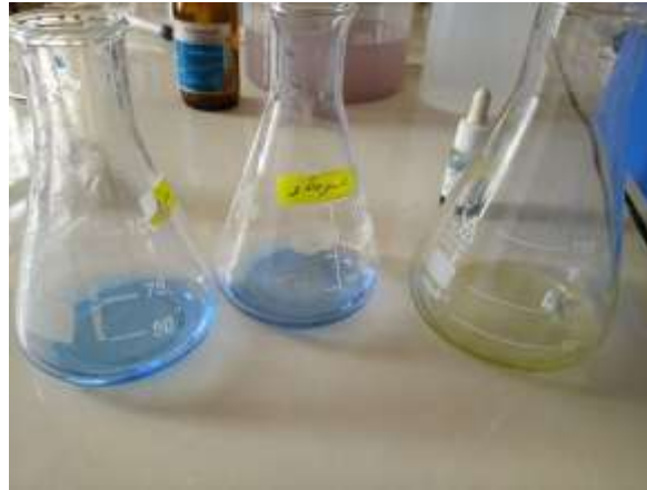
شكل رقم 12: عينات قبل وبعد معايرة البيكربونات
