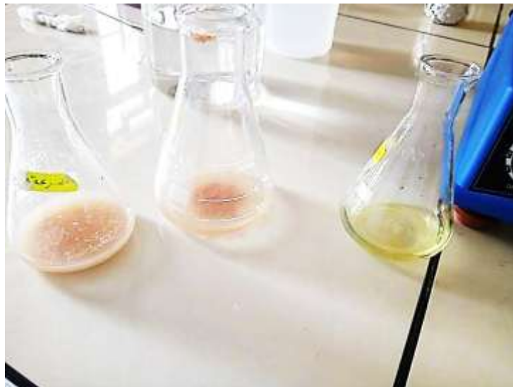
شكل رقم 11: عينات قبل وبعد معايرة الكلور
