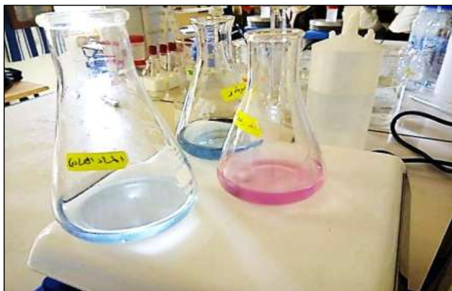
شكل رقم 9: عينات قبل وبعد معايرة الكالسيوم
