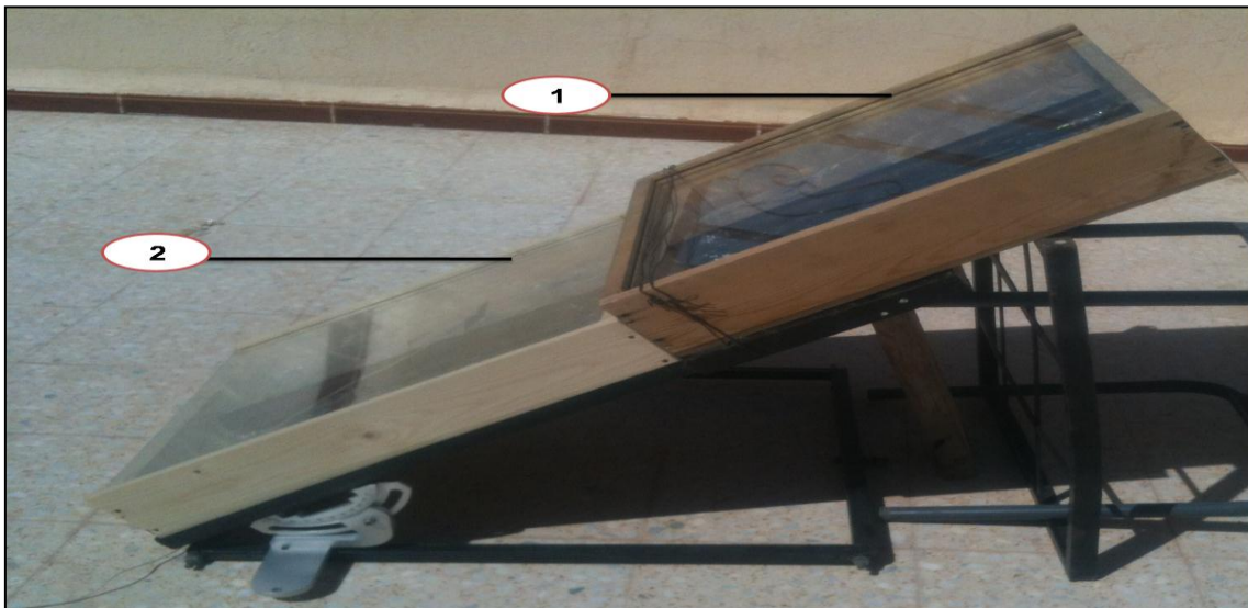
الشكل (2-3) صورة للاقط الشمسي أثناء دراسة تأثير الغطاء الزجاجي
