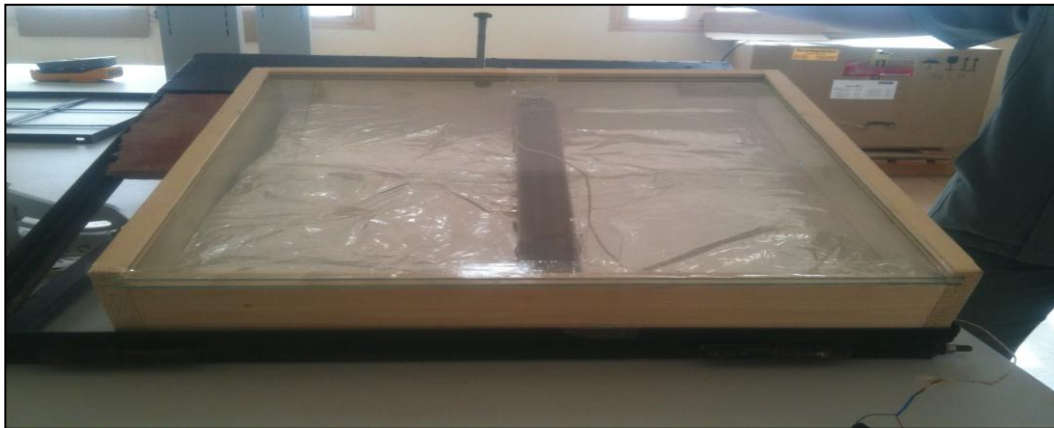
الشكل (6-2) : صورة توضح تركيب اللاقط المنجز
