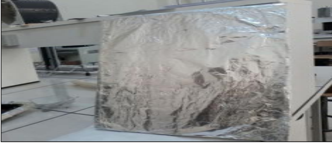
الشكل (5-2) : العازل الذي يفصل بين الأنبوب النحاسي والصندوق الخارجي
