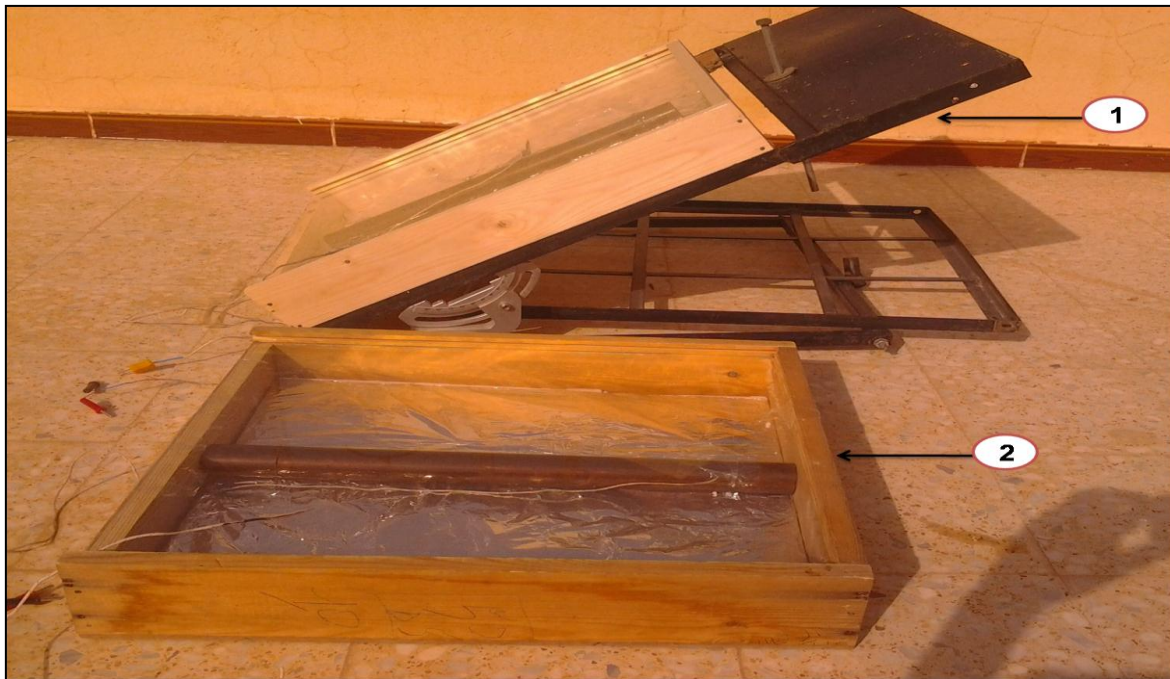
الشكل (1-3) صورة للاقط الشمسي أثناء دراسة تأثير الزاوية
