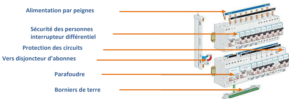
Figure I.1. Exemple d'un tableau électrique
