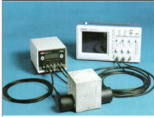
Figure1.5 : Appareil d'auscultation sonore 58-E48 avec oscilloscope
