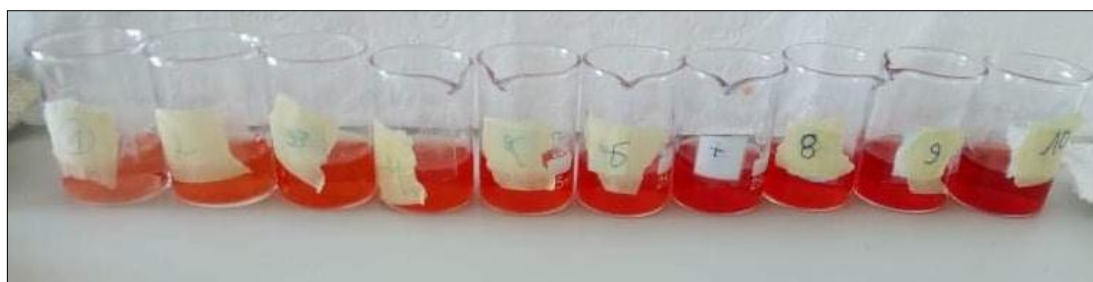
الصورة 13.III تجربة المعايرة لأحمر الكونغو
