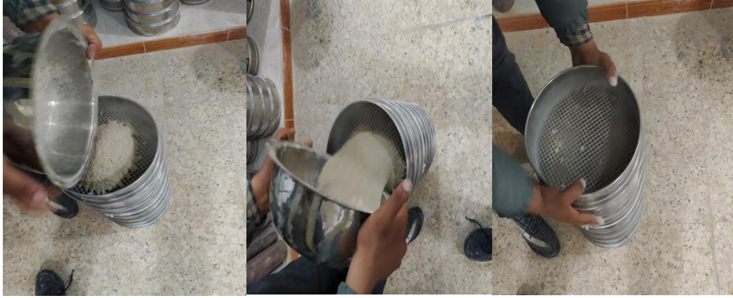
الصورة III. 5 تجربة التدرج الحبيبي.
