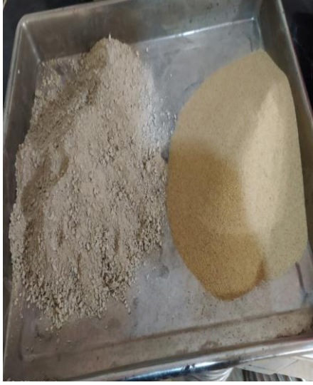
صورة توضح كيفية تخليط رمل المحاجر مع رمل الكثبان
