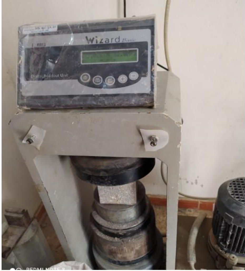
الصورة IV. 2 تجربة آلة التحطيم بالضغط
