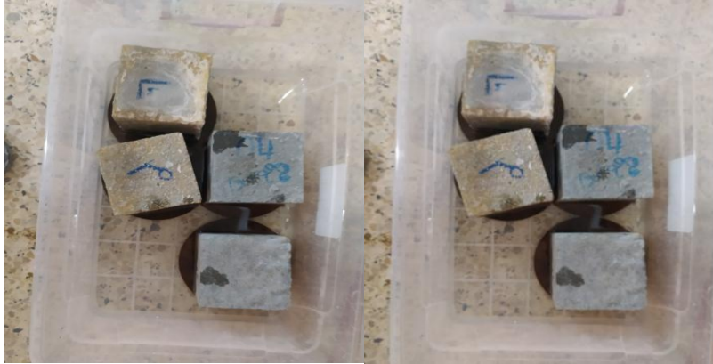
الصورة IV. 5 تجربة امتصاص (الماء الخاصية الشعرية).
