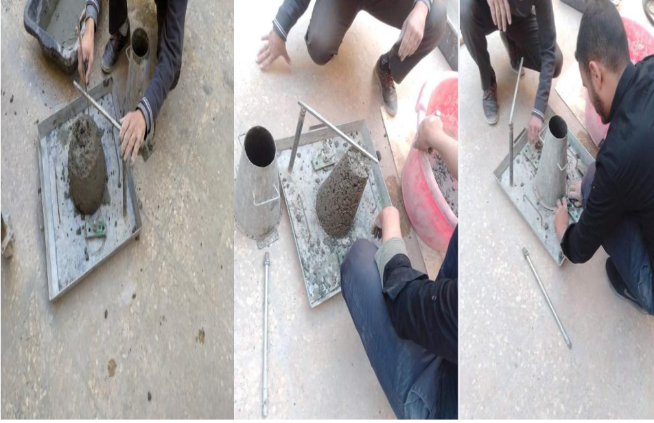
صورة توضح تجربة قياس التشغيلية بواسطة مخروط أبرامز قبل وبعد إضافة الملدن
