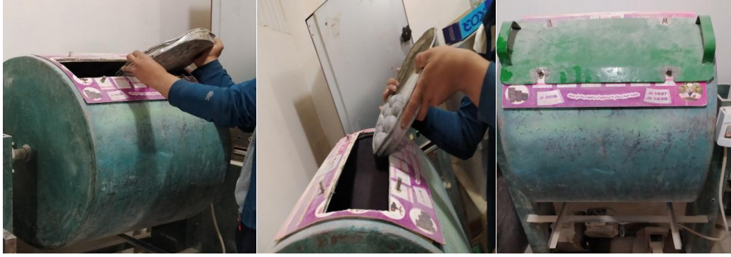
الصورة III. 7 تجربة الصدام للحصى (لوس انجلوس)
