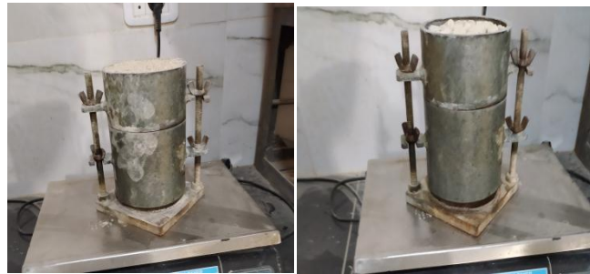
الصورة III.1 تجربة الكتلة الحجمية الظاهرية (الحاوية).
