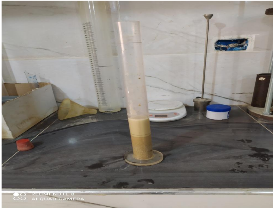
صورة تجربة المكافئ الرملي لتركيبة SC60%SD40
