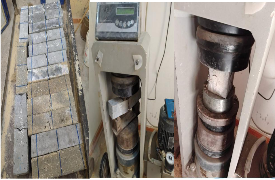
صورة توضح عينات أثناء تجربة ضغط والانحناء (وعينات بعد تجربة الانحناء)
