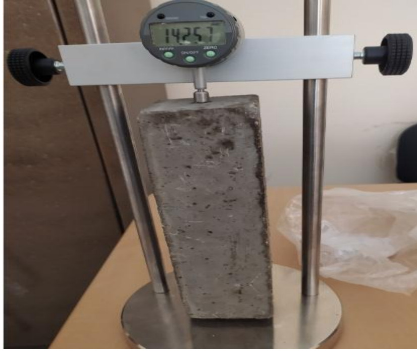
الصورة IV.3 توضح جهاز قياس الانكماش
