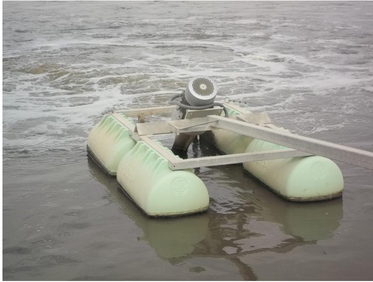
الشكل (III-14): مضخات تستخدم لضخ الهواء.
