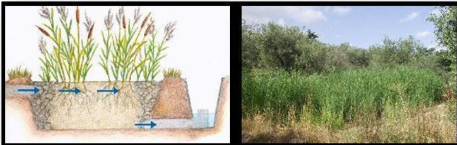
الشكل (II-5): النباتات المائية ضمن أحواض المعالجة بالنباتات.
