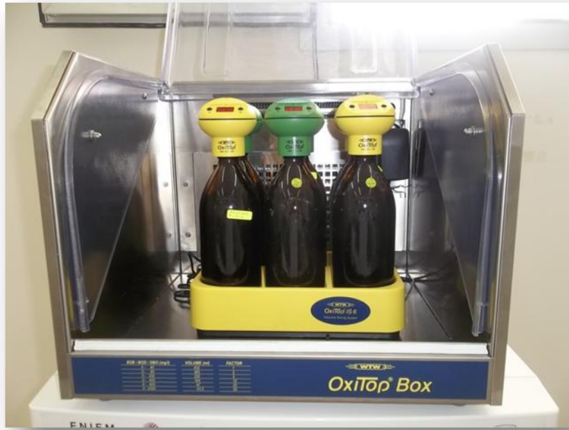
الشكل (5-IV): يمثل جهاز قياس الطلب للأوكسجين الحيوي (DBO5) .
