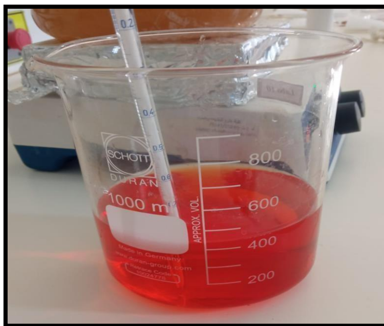
Figure 12: Coloration rouge-orangée du milieu réactionnel indiquant la formation des nanoparticules de sélénium (SeNPs).
