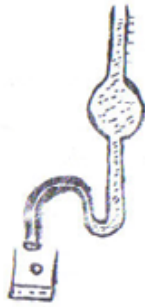
الشكل(4): جهاز قياس التوتر السطحي بطريقة القطرة.
