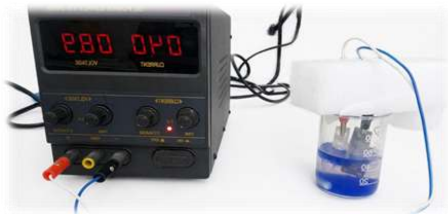
الشكل II-3: تركيب تجريبي لنظام كهروكيميائي للقطبين.
