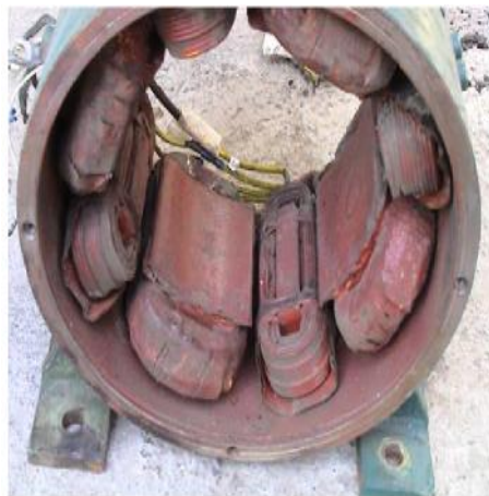
Photo 1. Stator d'une MCC
