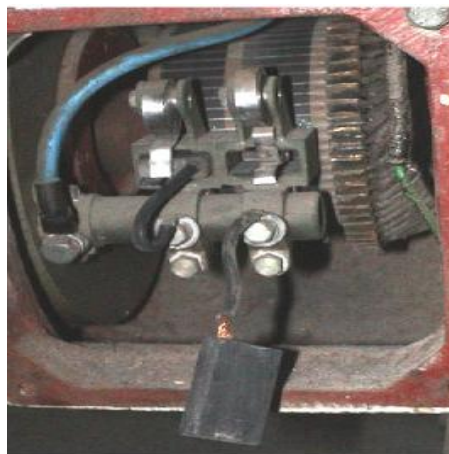
photo 3. Balais (en bas) et collecteur d'une MCC
