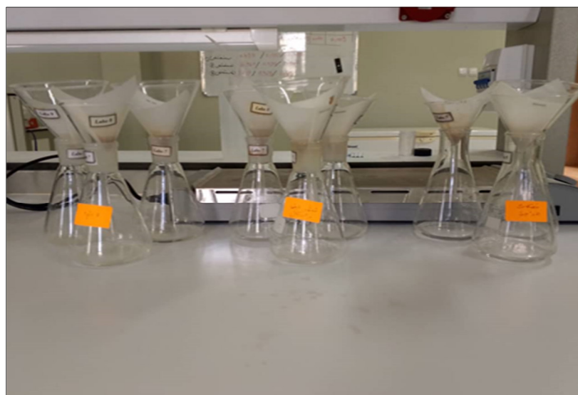
الصورة 9: عملية ترشيح عينات التربة.
