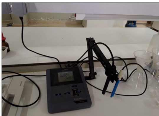
الصورة 10: قياس حموضة التربة pH بجهاز pH mètre
