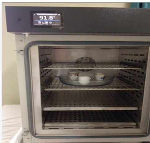
الصورة 7: تجفيف العينات في المجفف الكهربائي
