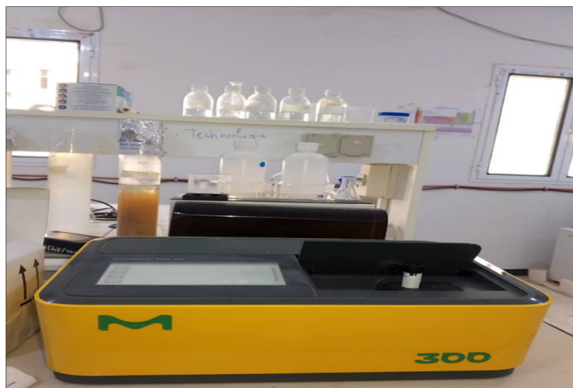
الصورة 15: جهاز المطياف الضوئي من نوع Spectroquant لتقدير الكلور
