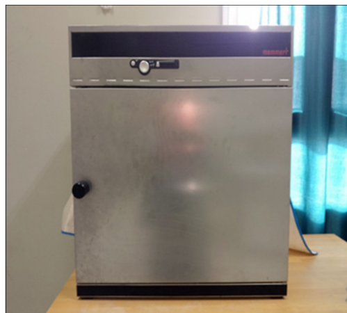
الصورة 7: تجفيف العينات في المجفف الكهربائي
