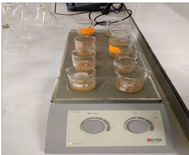
الصورة 8: تحضير العينات في المخلاط المغناطيسي.
