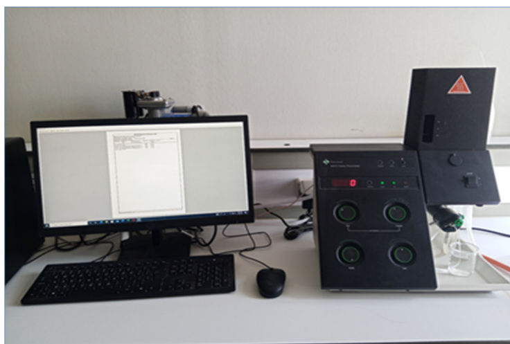
الصورة 14: جهاز Spectrophotomètre démission à flamme لتقدير الأملاح المعدنية
