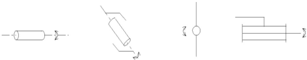
Figure II.5: Symbole de l'articulation rotoïde
