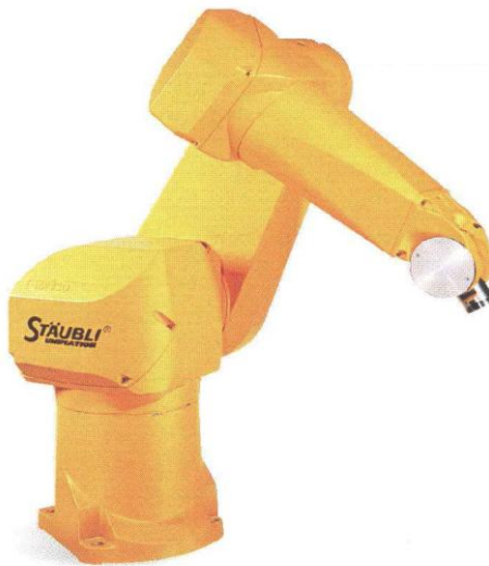
Figure II.3 :ROBOT STÄUBLI RX 90
