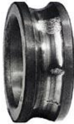
Figure. I.8. Ecaillage d'une piste de roulements dus à des surcharges mécaniques.
