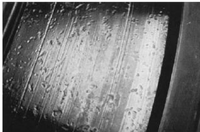
Figure. I.12. Marques d'indentation d'un le piste des roulements dus à la présence de contaminant.
