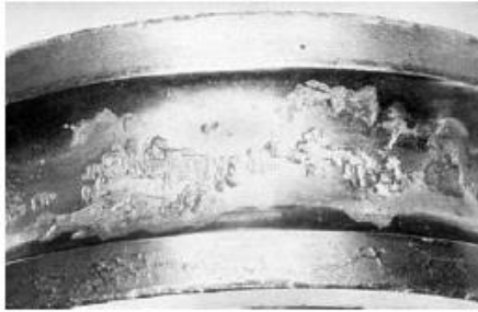
Écaillage d'un chemin de roulement
