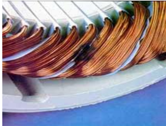
Figure. I.5. Court-circuit entre spires statoriques.
