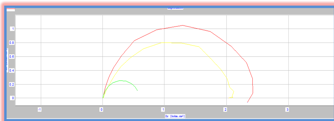
الشكل (67) : منحنى المطيافية Z_i=f(Z_r) الخاص بالمحلول HCl .
