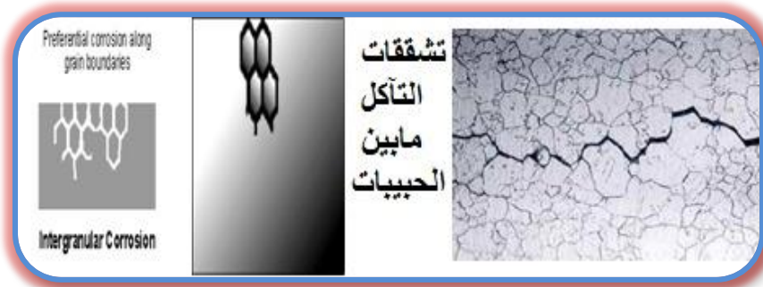
الشكل (10): صورة لتآكل بين الحبيبات
