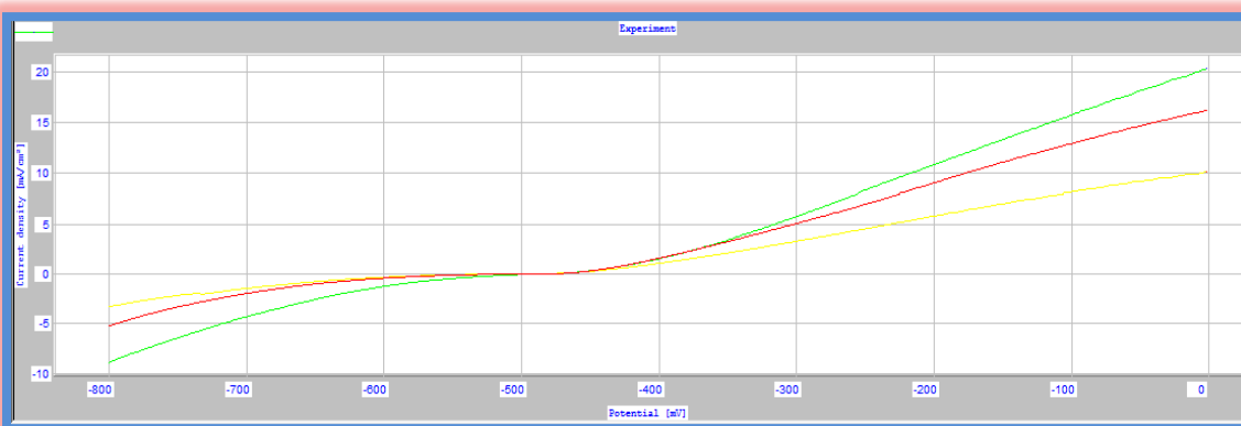
الشكل (65): منحنيات الاستقطاب لفولاذ الكربوني لمختلف تراكيز المثبط في الوسط الحمض H₂SO₄ (5%).
