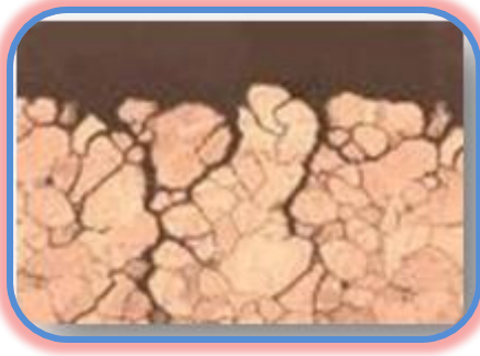
الشكل (9): صورة لتآكل الإجهادي
