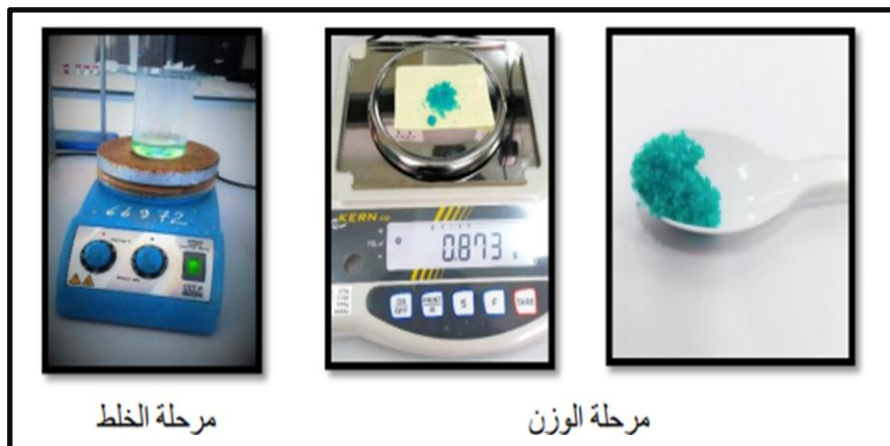
الشكل (6.III): خطوات تحضير محلول النيكل النقي.
