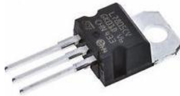
Figure 3.7. Régulateur de tension.
