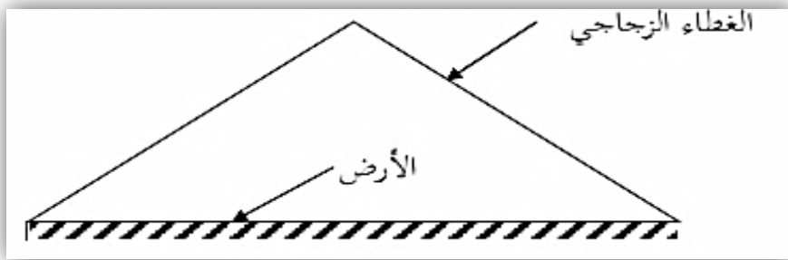
الشكل (10): مقطر شمسي أرض-ماء.
