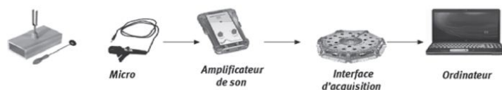
Figure 1.4: Processus d'acquisition d'un signal. [11].
