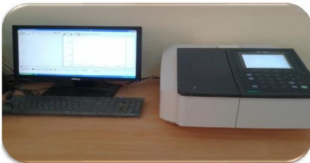
Figure (III.3): Spectrophotomètre UV-visible.
