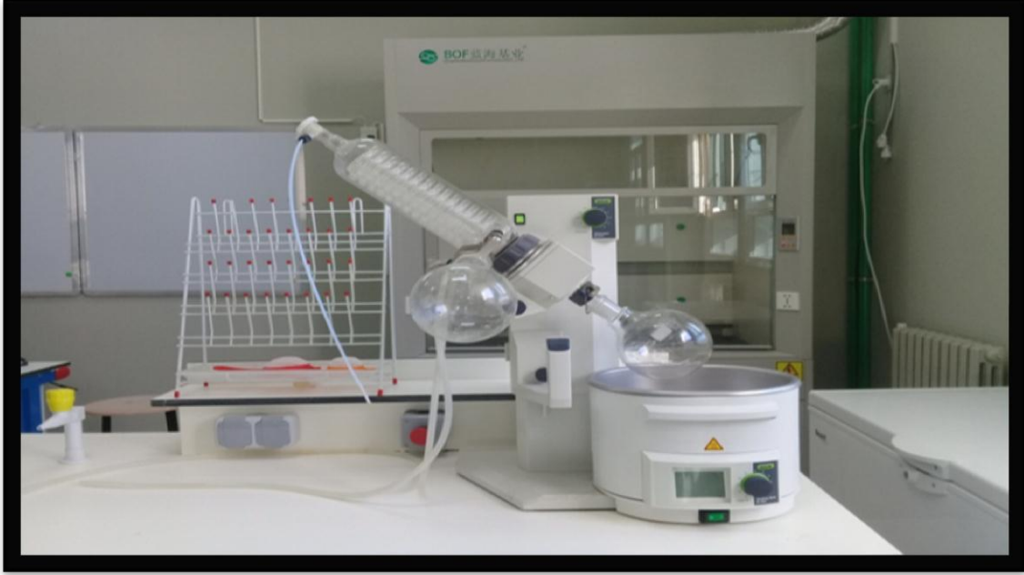
الملحق (5): صورة فوتوغرافية توضح جهاز المبخر الدوراني Rotavapour
