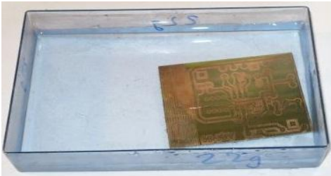
الصورة رقم 35: اللوح في محلول هيدروكسيد الصديوم
