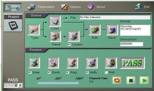
الصورة رقم 42: امر حرق الشيفرة داخل ذاكرة المتحكم
