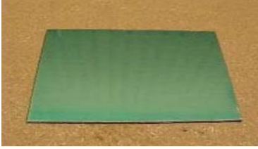
الصورة رقم 33: اللوح النحاسي للدارة المطبوع
