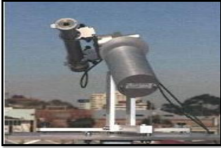
الشكل (5-1): صورة لجهاز مايكلسون لقياس الإشعاع الشمسي المباشر [7].
